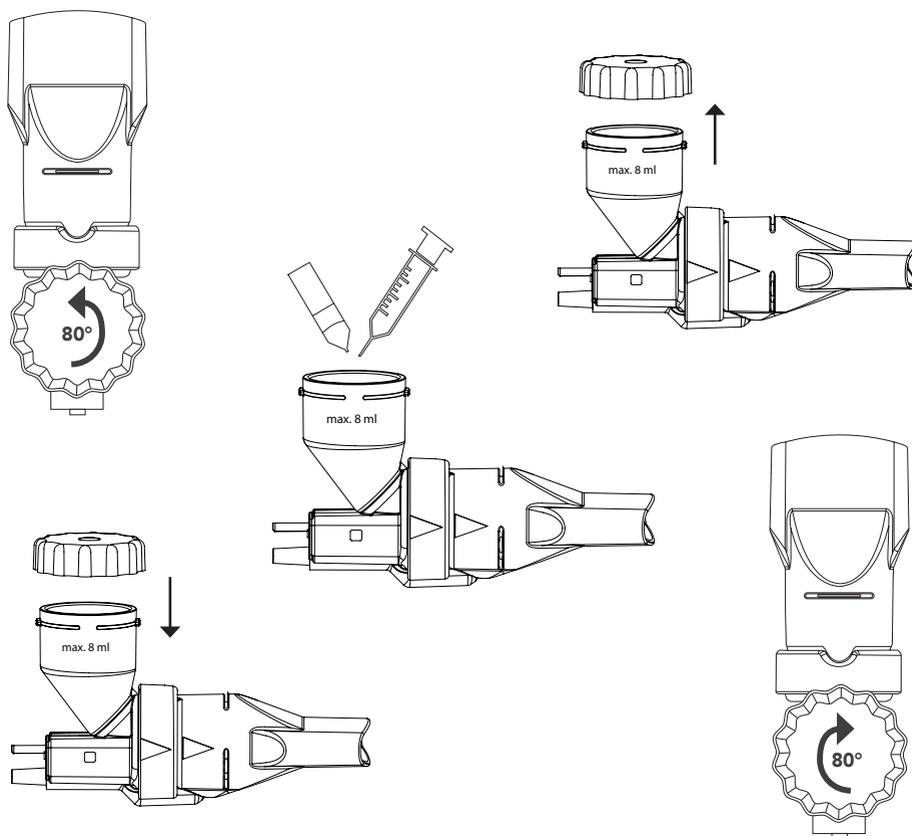
Abb. 02 - MN-300/8 - M-neb® dose+ Verneblereinheit befüllen
