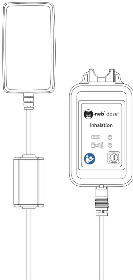
Abb. 08b - MN-300/8 - Aufladen der M-neb® dose+ Steuereinheit
