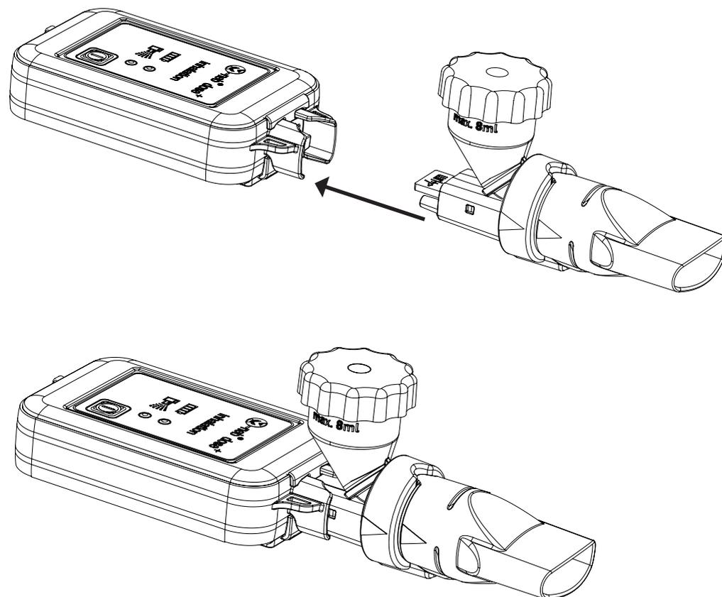
Abb. 03 - MN-300/8 - M-neb® dose+ Verneblereinheit mit M-neb® dose+ Steuereinheit verbinden
