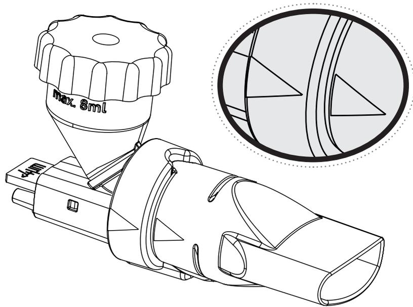
Abb. 05 - MN-300/8 - Richtung des Gasvolumenstroms
