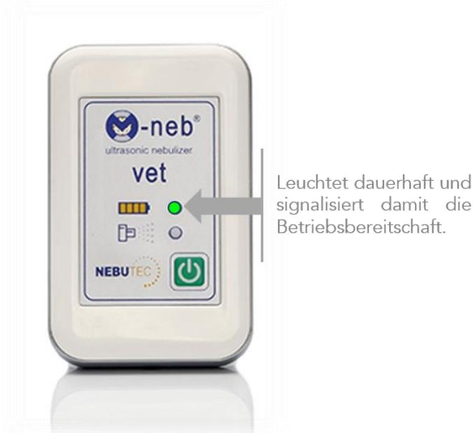
Die Grundeinstellung der Steuereinheit ist der intermittierende Modus. Im intermittierenden Modus produziert die Mesh-Verneblereinheit eine Sekunde Aerosol und setzt anschließend für eine Sekunde mit der Aerosolproduktion aus (eine Sekunde aktiv / eine Sekunde passiv). Dabei leuchtet die Batterie-Statusanzeige dauerhaft grün. Die Betriebsmodus-Statusanzeige leuchtet in der aktiven Phase blau auf und erlischt für die Dauer der passiven Phase.
